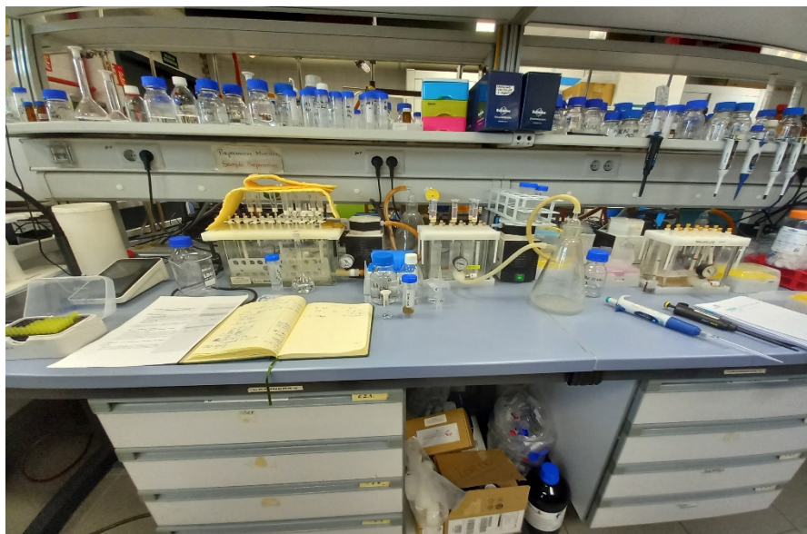
Sistemul de extracție în fază solidă utilizat în analiza compușilor de interes din extracte lichide
