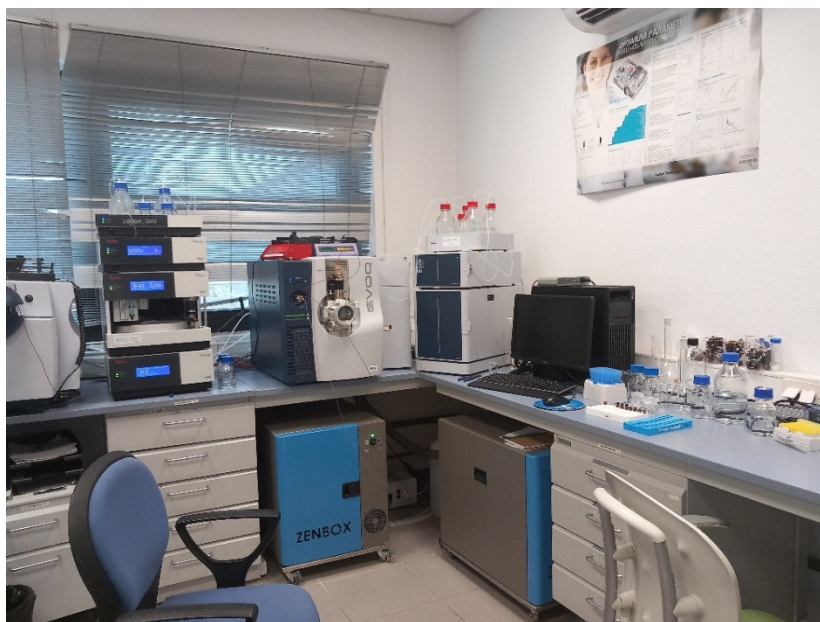
Sistem Elute HPLC (Bruker Daltonics Inc, Billerica, MA, SUA) echipat cu detector spectrometru de masă tandem triplu cuadripol (EVOQ® Elite, Bruker)
